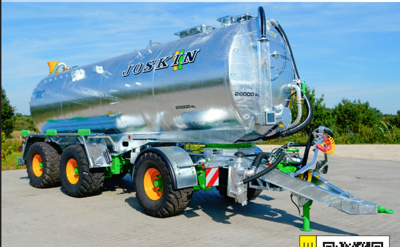
Tetraliner: dyszel Dolly z zawieszeniem pneumatycznym
